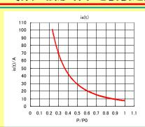
随着气体压强的减小,表面过程中的放电电流迅速增加
