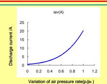
随着气体压强的减小,气体电子雪崩过程中的放电电流迅速减小
